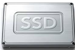
SSDとは、フラッシュメモリを用いたパソコン用の記憶装置のこと。SSDの内部にはフラッシュメモリチップがびっしりと並べられており、USBメモリと基本的には同じです。ただしUSBメモリはただのメモリチップですが、SSDにはコントローラがついており、データの処理速度を向上させたり、寿命を延ばしたりする工夫がされています。その為、HDDと比べ、データ処理が高速・耐衝撃性が高い・軽量・省電力・低発熱・静音など、HDDにはない利点がたくさんあります！
